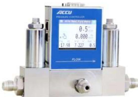
Цифровые измерители и регуляторы давления АСУ20РСД работают в диапазоне давлений: от мин. **0,05...1 бар** до макс. **10...200 бар (абсолютное или избыточное)** с точностью 0,5% от ВПИ.
